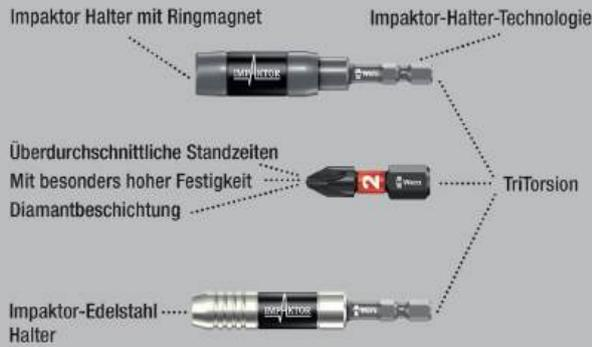
Wera Impaktor Halter zur Abfederung extremer Impulsspitzen. Besonderer Torsionseffekt durch Doppeltorsionsfeder. Der Sprengring garantiert optimalen Sitz des Werkzeugs im Halter.
