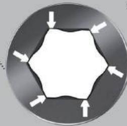
Hex-Plus bietet größere Anlageflächen im Schraubenkopf. Die Kerbwirkung wird dadurch auf ein Minimum reduziert, die Zerstörung des Schraubenkopfes nahezu eliminiert.
