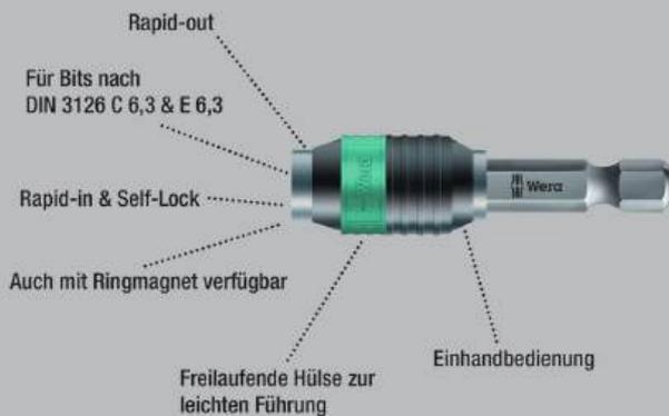
Universalhalter für die Aufnahme von Bits mit 1/4"-Außensechskantantrieb nach DIN ISO 1173-C 6,3 und E 6,3 (ISO 1173). Edelstahlausführung zur Vermeidung von Fremdstoffen.
