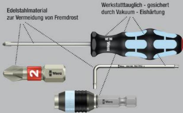
Hochwertiger Kraftform Plus Schraubendreher aus Edelstahl. Die Edelstahlwerkzeuge von Wera sind vakuumeisgehärtet und verfügen damit über die für Verschraubungen benötigten Härten und Festigkeitswerte. Der industrielle Einsatz ist ohne Einschränkungen möglich.
