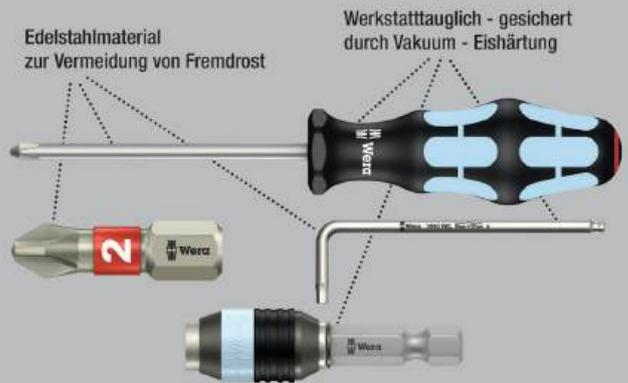
Wera Edelstahl Werkzeuge werden aus Edelstahl gefertigt, wodurch der unansehnliche Fremdstoff vermieden wird. Mit Torsionszone: Bei Torsion-Bits werden Drehmomentspitzen in der Torsionszone abgedeckt. Vorzeitiger Verschleiß wird vermieden, die Lebensdauer des Bits erhöht. 1/4"-Sechskant, passend für Halter nach DIN ISO 1173-D 6,3.
