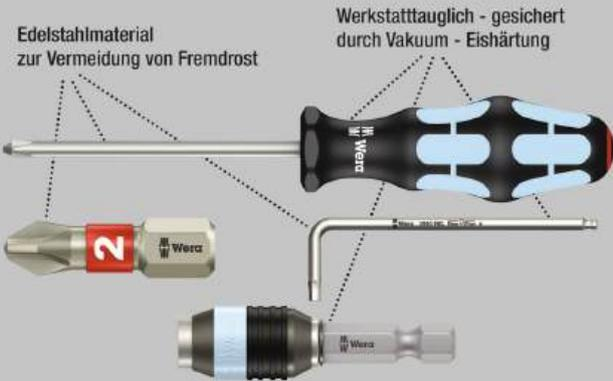
Hochwertige Bits aus Edelstahl für Pozidriv-Schrauben. Wera Edelstahl Werkzeuge werden aus Edelstahl gefertigt, wodurch der unansehnliche Fremdst vermieden wird. 1/4"-Sechskant, passend für Halter nach DIN ISO 1173-F 6,3.
