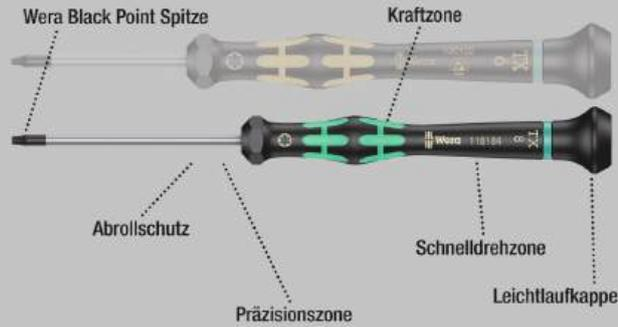
Hochwertiger Wera Micro Schraubendreher für feinmechanische Verschraubungen. Durch Abstützen der Hand auf der Drehkappe und durch die Schnell Drehzone unterhalb der Drehkappe ist blitzschnelles Zwirbeln möglich. Zeitintensives Umgreifen entfällt. Kraftzone mit integrierten Weichzonen sorgt für die Übertragung hoher Löse- und Anzugsmomente. Präzisionszone für den richtigen Drehwinkel bei Justierarbeiten.
