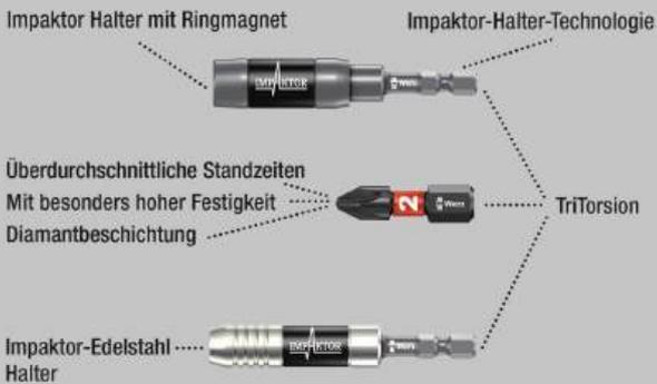
Bits für Innen TORX® Schrauben. Die Impaktortechnologie sorgt für überdurchschnittliche Standzeiten auch bei extremen Anforderungen. Erhöhter Reibungswiderstand durch raue Diamantpartikelbeschichtung auf der Bit Spitze verhindern das Herausrutschen aus der Schraube.
