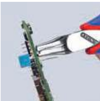
Zum Anbiegen eines Bogens als Spannungs-entlastung („stress relief“) / für Abstand zur Platine
