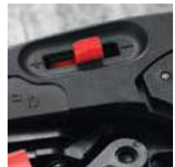
Die Feinjustierung ermöglicht zuverlässiges Abisolieren auch bei besonderen Einsatz- bedingungen (spezielle Isoliermaterialien oder extreme Temperaturen)
