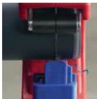
Auch kurze Abschnitte ab nur ca. 10 mm sind möglich. Der spiralförmige Span entsteht durch das Anfasen
