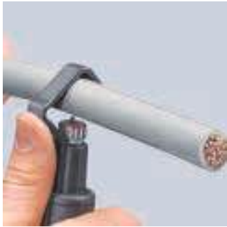
Ansetzen des Werkzeugs für Umfangsschnitt
