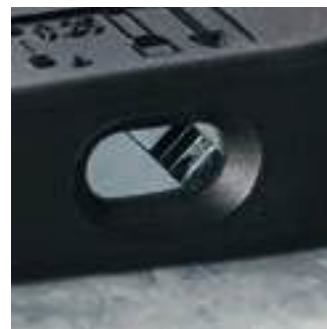
Vierkant-Crimpstelle für Aderendhülsen 0,25 – 4 mm 2
