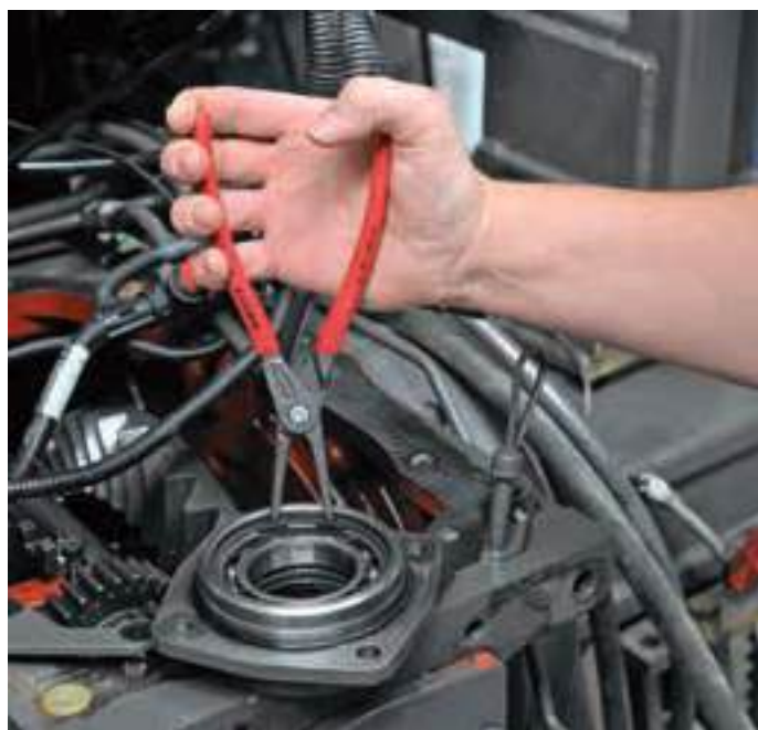
Stabile, eingesetzte Spitzen aus hochverdichtetem Federstahl
