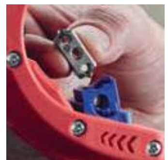
Wenn die Klinge abgenutzt ist, kann sie ohne Werkzeug gewendet oder ausgetauscht werden
