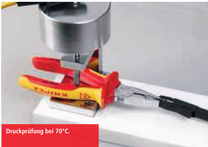
Prüfung der Haftfähigkeit der VDE-Hüllen mit 500 N.
