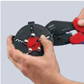
Crimpeinsatz-Wechsel: Magazinposition entsperren, Crimpeinsatz in der Zange entnehmen
