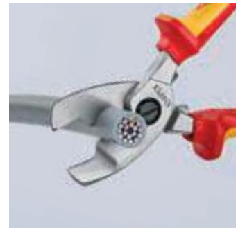
Nachschnitt: Nachdem der Mantel des Kabels im vorderen Profil durchgeschnitten wurde, werden die Leiter im hinteren Profil durchtrennt. Vorschnitt vorn, Nachschnitt hinten – so schneidet es sich leichter.
