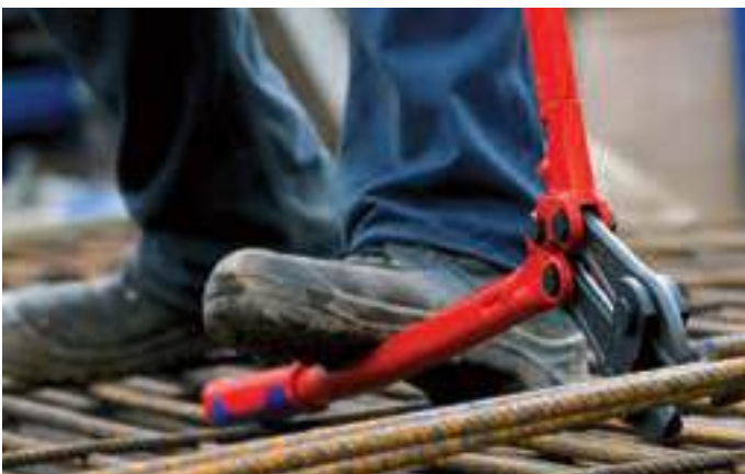
Angeschmiedeter Anschlag mit Dämpfung-Einsatz: dämpft den Schnittschlag komfortabel ab
