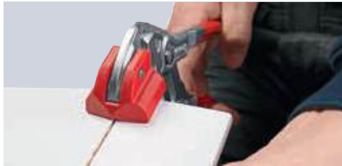
Kunststoff-Anlagebacke: schwenkbar für einen sauberen Bruch und optimalen Schutz der Fliese vor Beschädigungen
