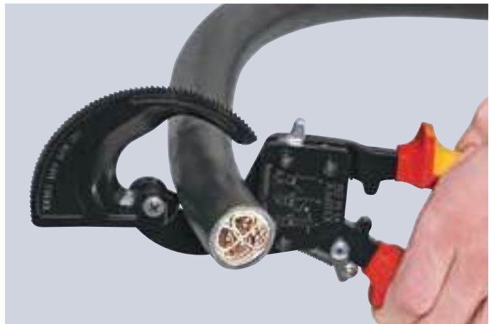
Ratschenprinzip und Zweigang-Zahnkranz-antrieb für kraftsparendes Schneiden
