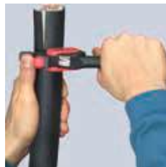
Drehen des Werkzeugs für Umfangsschnitt
