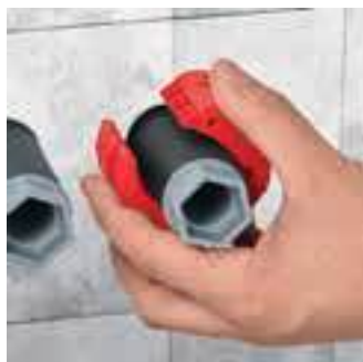
Durch die einzigartige Konstruktion des drehbaren Messerblocks lassen sich Tropf- und Dichthülsen zuverlässig 2 bis 3 mm vor der Wand einkürzen, um Feuchtigkeit sicher abzuleiten.
