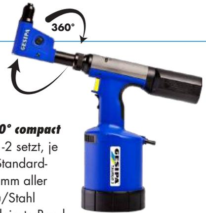
Der **Winkelkopf 90° compact** für den TAURUS® 1-2 setzt, je nach Geräte-Typ, Standard-Blindniete bis Ø 5 mm aller Werkstoffe und Alu/Stahl bis Ø 6 mm. Der kleinste Randabstand beträgt 12 mm, die Kopflänge 90 mm. Er besitzt eine Setzkraft bis 10 kN. Beide Winkelköpfe sind in jeder Stellung (360°) frei auf der TAURUS®-Zugachse positionierbar.
