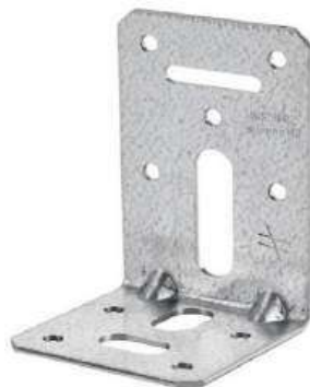
Winkelverbinder mit beidseitigem Langlöchern bietet eine vielfältige Montageausgleichsmöglichkeit inkl. einer Rippenverstärkung
