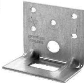
Winkelverbinder mit einseitigem Langloch, bietet eine Montageausgleichsmöglichkeit inkl. einer Rippenverstärkung
