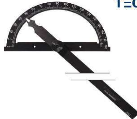
Promat Winkelmeßer Gradbogen mit mattverchromter Skala, oberflächengehärtetes Aluminium (HRc 62) schwarz eloxiert · offener, halbrunder Gradbogen 0 - 180°
