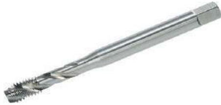
Völkkel Maschinengewindebohrer Form C/35°RSP für metrisches ISO-Gewinde - DIN 371 - HSS-E ab M12 nach DIN 376 - alle für Sacklöcher
