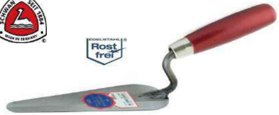
Schwan Katzenzungenkelle Blatt und Angel aus rostfreiem Edelstahl feingeschliffene Oberfläche, Buchenholzheft
