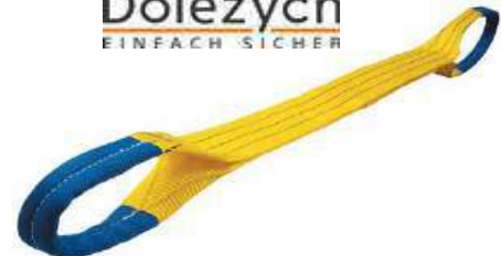
Dolezych Hebeband "DIN EN 1492-1" Polyesterband formstabilisiert und imprägniert mit 7-facher Sicherheit durch Farbcodierung der Tragfähigkeit mit 2 verstärkten Schlaufen - GS (geprüfte Sicherheit)
