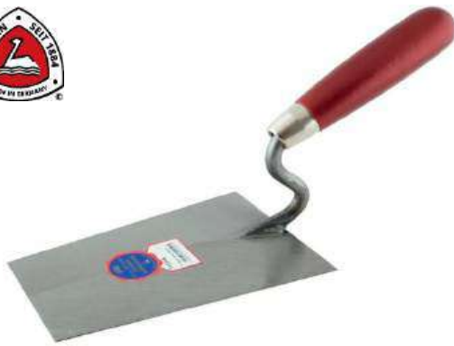
Schwan Putzkelle Qualitätsstahl, Schwanenhals (S-Hals) · konisch geschliffenes Blatt · verzinkte Zwinge · polierter Grat · lackiertes Buchenholzheft, 180 mm nach DIN 6440C
