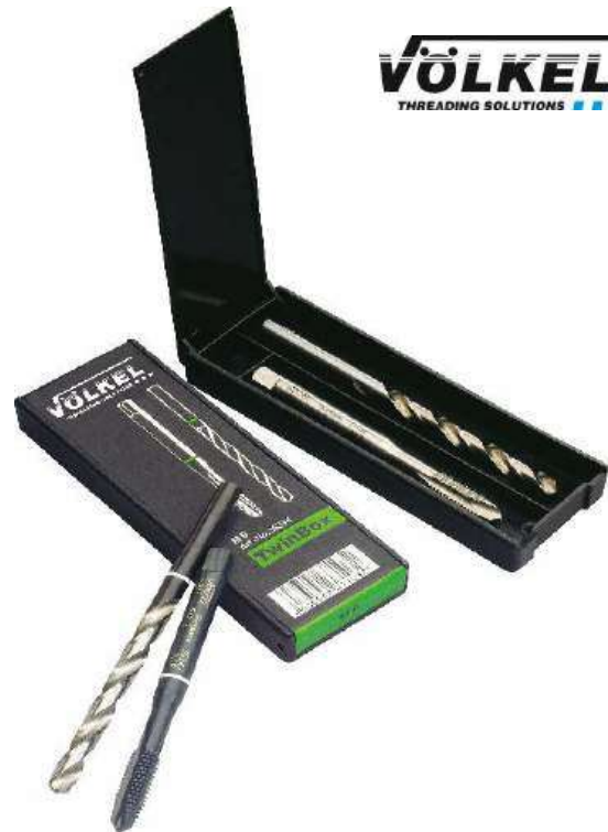
Völkel TWINBOX Maschinengewindebohrer + Spiralbohrer Grünring nach ISO-Gewinde DIN 13 Form.C - 35° Rechtsspirale für den allgemeinen Einsatz für gut zerspanbare Werkstoffe bis 1000 N/mm 2 , unlegierte und niedriglegierte Stähle, Temporguss & Zinklegierungen - zusammen in praktischer Kunststoffbox
