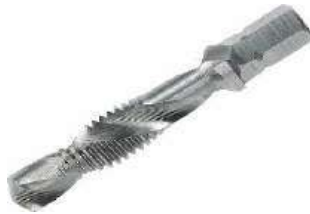
Völkkel Kombi-Bits - HSS-G - für metrisches Gewinde zum Kernlochbohren, Gewindeschneiden & Entgraten in einem Arbeitsgang mit 1/4" Aufnahme
