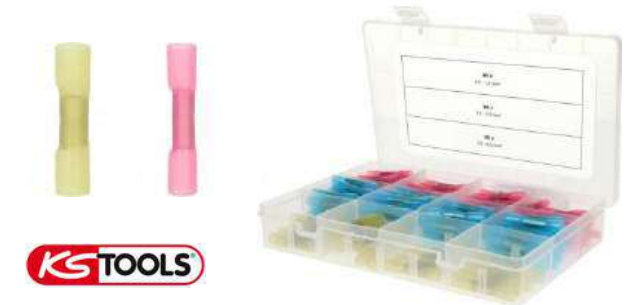
KS-Tools Schrumpfstoßverbinder, 0,5 mm 2 - 6,0 mm 2 , 200-tlg geeignet für Kabelquerschnitte: rot 0,5 - 1,5 mm 2 , blau 1,5 - 2,5 mm 2 , gelb 4,0 - 6,0 mm 2
