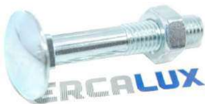
DIN 603/555 - Schlossschrauben m. Mutter Stahl 4.6 galv. verzinkt
