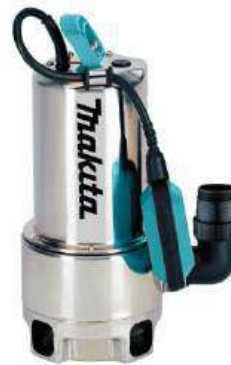
Eine robuste elektrische Klar- und Schmutzwasserpumpe mit rostfreiem Edelstahlgehäuse. Für eine Fördermenge bis 15.000 l/h Partikelgrößen bis 35mm - Mindestwasserstand 50mm. Mit automatischer Abschaltung durch einstellbaren Schwimmschalter
