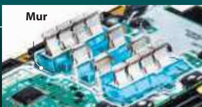
**Structure de protection contre les courts-circuits des points de connexion :** le mur de protection est placé entre les points de connexion pour les protéger contre l'eau et la poussière.
